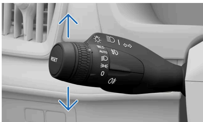
Les clignotants sur le levier gauche
