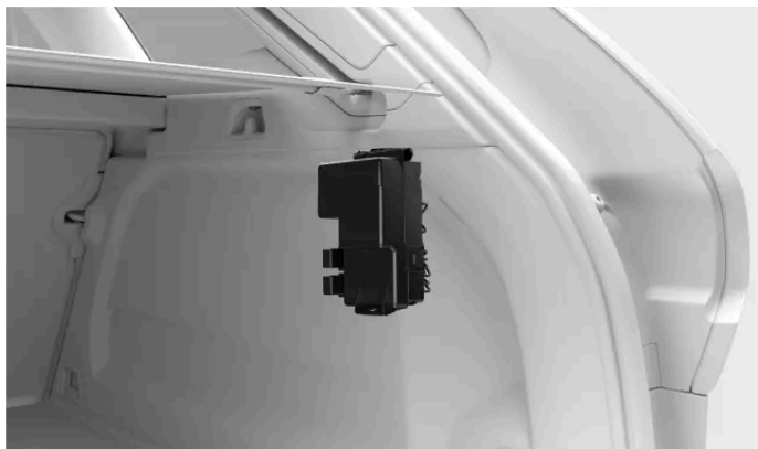
Emplacement du boîtier à fusibles
