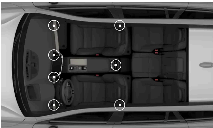
Emplacements des bouches d'air réglables
