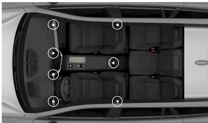
Emplacements des bouches d'air réglables
