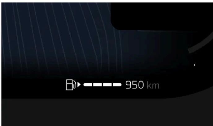
L'autonomie dépend principalement de la quantité de carburant qui reste dans le réservoir de votre voiture et de vos habitudes de conduite, mais les conditions extérieures peuvent également jouer un rôle. L'indicateur de niveau de carburant et l'autonomie prévue sont affichés dans l'écran du conducteur.
