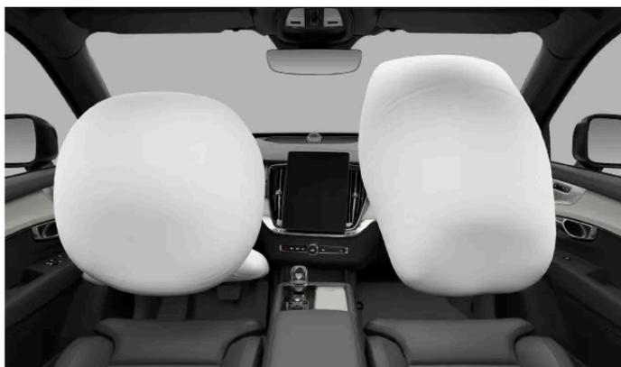
Le côté conducteur est équipé de deux coussins gonflables frontaux. Le coussin gonflable supérieur est logé à l'intérieur du volant et celui pour genoux est logé derrière un panneau sous le volant.
