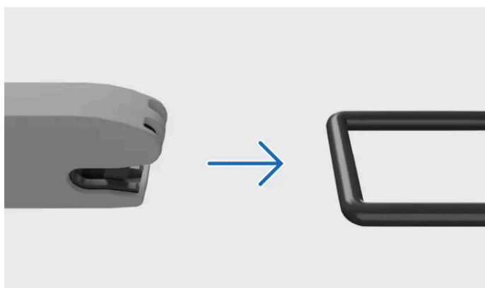
Fixation au point d'ancrage ISOFIX [1]
