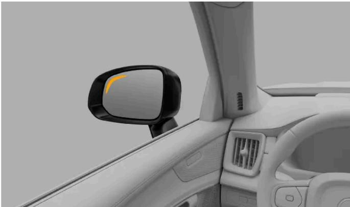
Lorsqu'un véhicule est détecté dans votre angle mort ou qu'il s'en approche, une lumière apparaît dans le rétroviseur extérieur.
