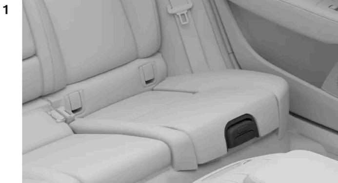
Tirez la poignée située à l'avant du coussin de siège pour déverrouiller le siège.
