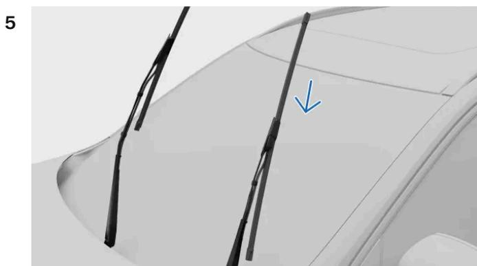
Assurez-vous que le balai du côté conducteur est plus long que celui du côté passager. Glissez le balai d'essuie-glace sur le bras d'essuie-glace. Assurez-vous que la goupille du bras d'essuie-glace s'insère dans le trou du balai d'essuie-glace. Poussez le balai dans le bras d'essuie-glace jusqu'à ce que vous entendiez un déclic.
