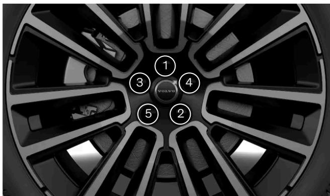
Serrez les boulons de roue en diagonale.
