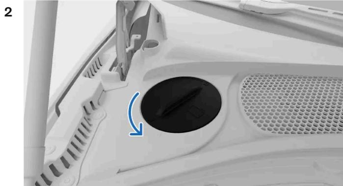
Ouvrez la trappe du panneau dans le coin supérieur gauche du compartiment moteur pour accéder au réservoir de liquide de refroidissement.
