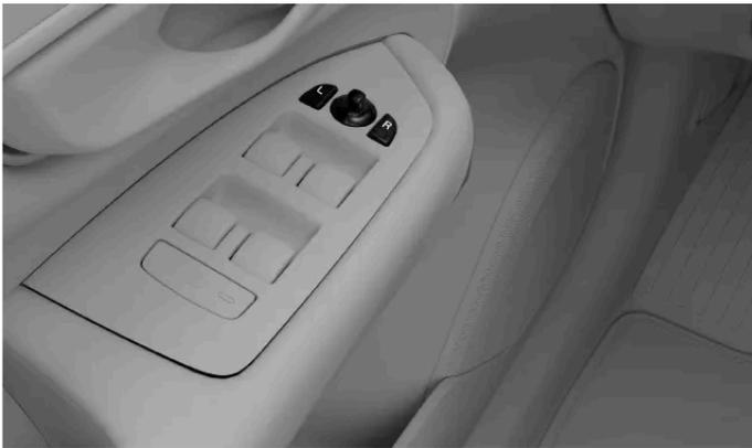
Commandes de réglage des rétroviseurs extérieurs
