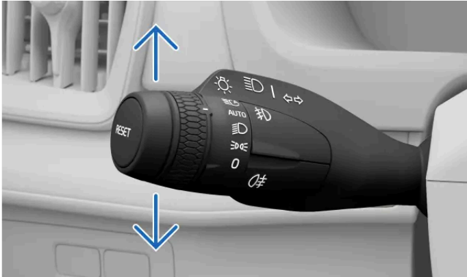
Les clignotants sur le levier gauche
