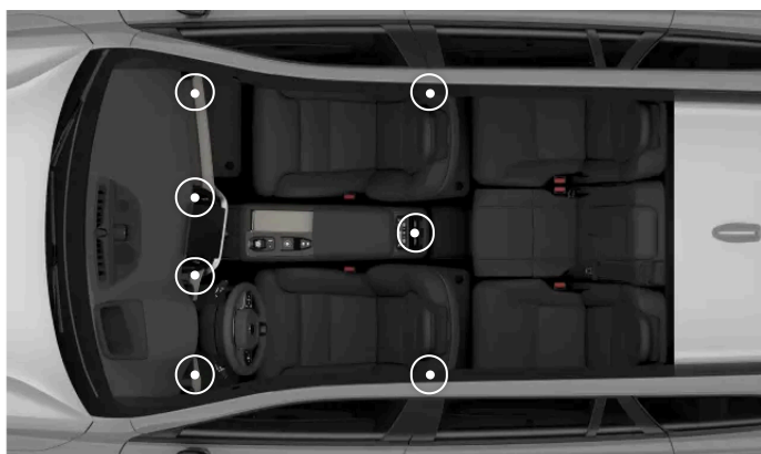
Emplacements des bouches d'air réglables
