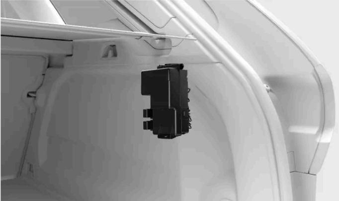
Emplacement du boîtier à fusibles
