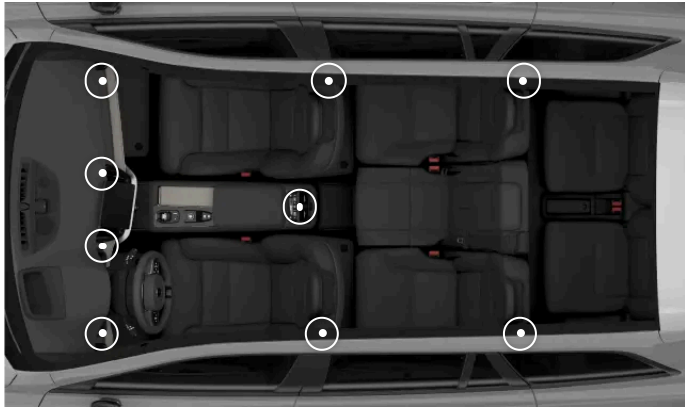
Emplacements des bouches d'air réglables
