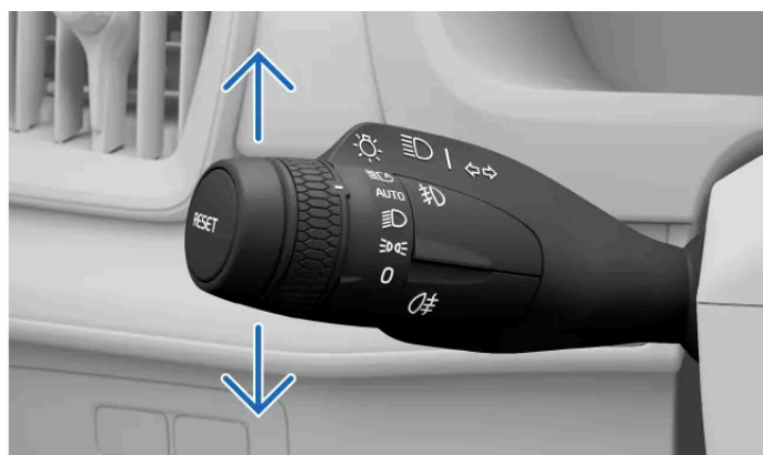
Les clignotants sur le levier gauche
