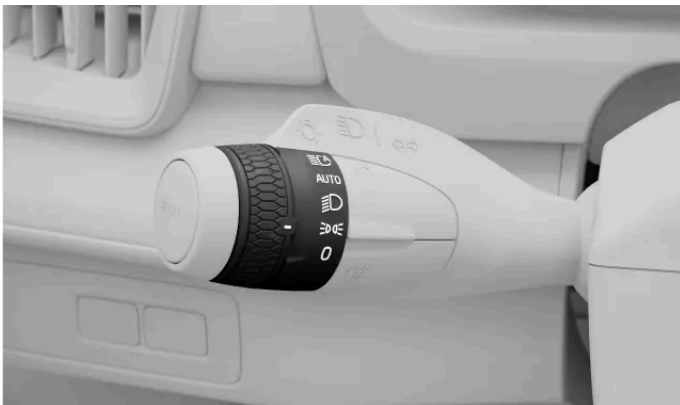
Le symbole des feux de position sur la bague rotative du levier gauche
