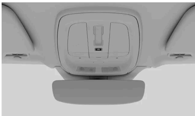
Le bouton d'extinction automatique des lumières situé sur la console au pavillon
