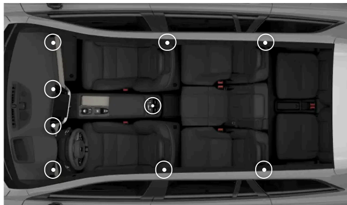
Emplacements des bouches d'air réglables
