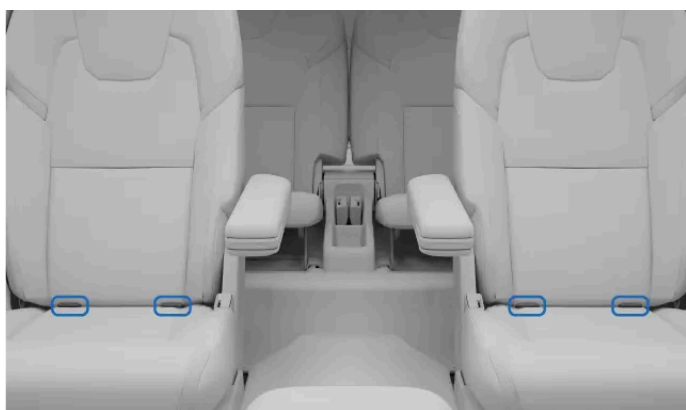
Emplacement des points d'ancrage ISOFIX [1] pour les sièges de la deuxième rangée
