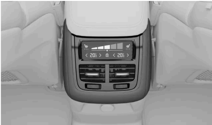
Commandes de climatisation dans la console centrale
