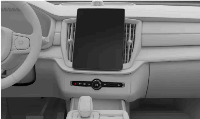
Boutons de dégivrage et d'écran central sur le panneau de commande situé sous l'écran central
