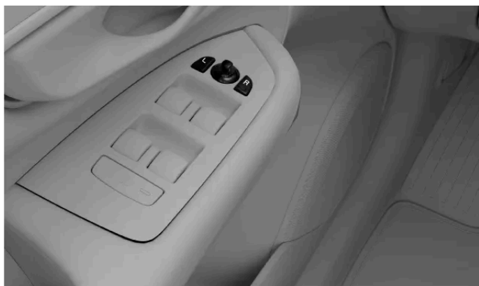
Commandes de réglage des rétroviseurs extérieurs
