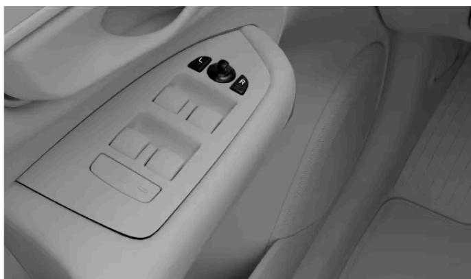
Commandes de réglage des rétroviseurs extérieurs
