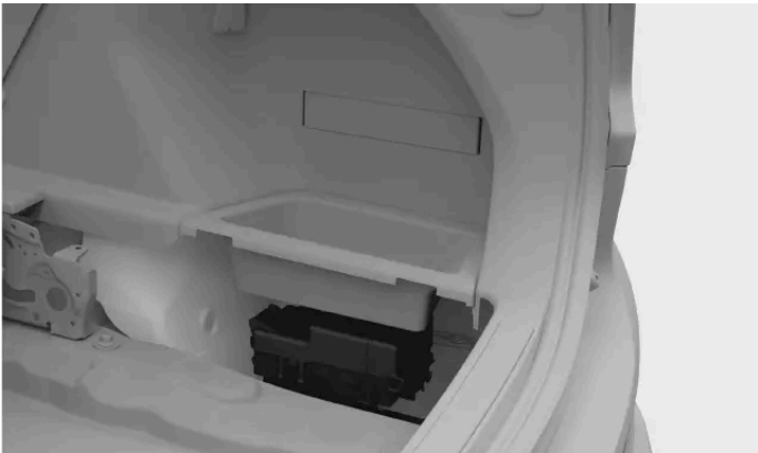
Emplacement du boîtier à fusibles
