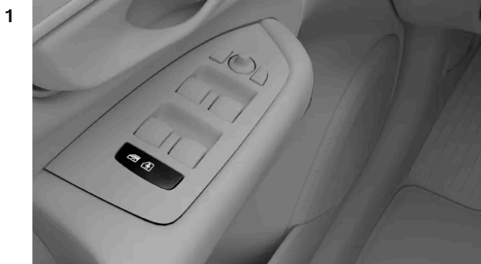
Emplacement du bouton de verrou de sécurité pour enfants dans le panneau de porte
