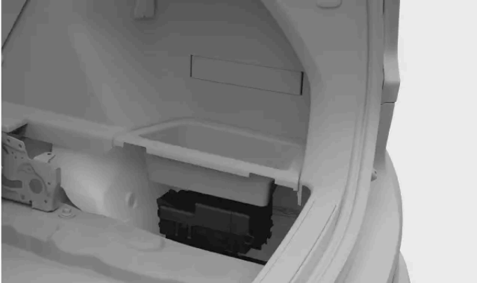
Emplacement du boîtier à fusibles
