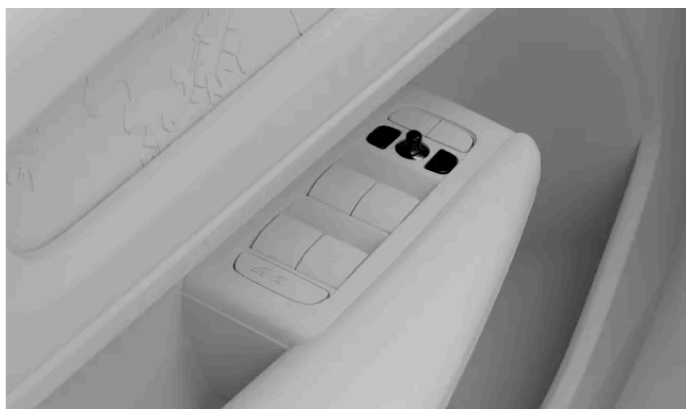
Ovládací prvky pro nastavení vnějších zpětných zrcátek
