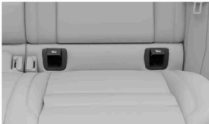
Umístění kotevních bodů ISOFIX na krajních zadních sedadlech
