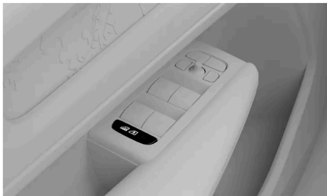
Umístění tlačítka dětské pojistky na vnitřním panelu dveří
