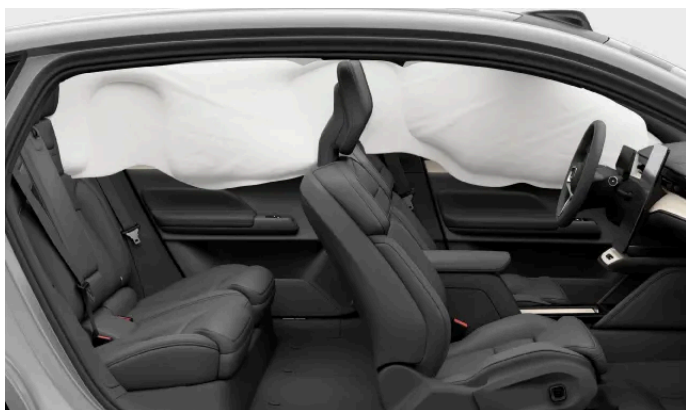
Nafouknutý hlavový airbag na jedné straně vozidla.
