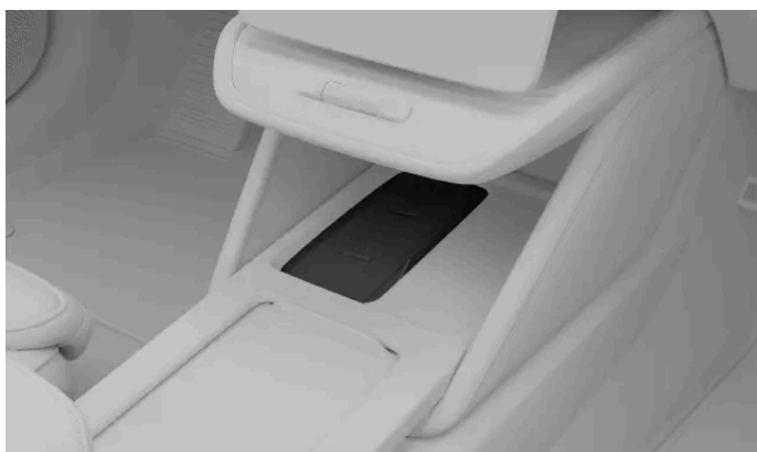
Čtečka klíčů mezi předními sedadly slouží i jako bezdrátová nabíječka.
