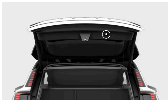
Umístění tlačítka zavírání kufru.
