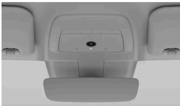
Tlačítko odmrazování na stropním panelu
