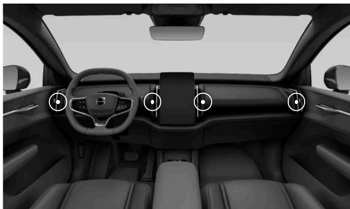
Rozmístění nastavitelných ventilačních otvorů.
