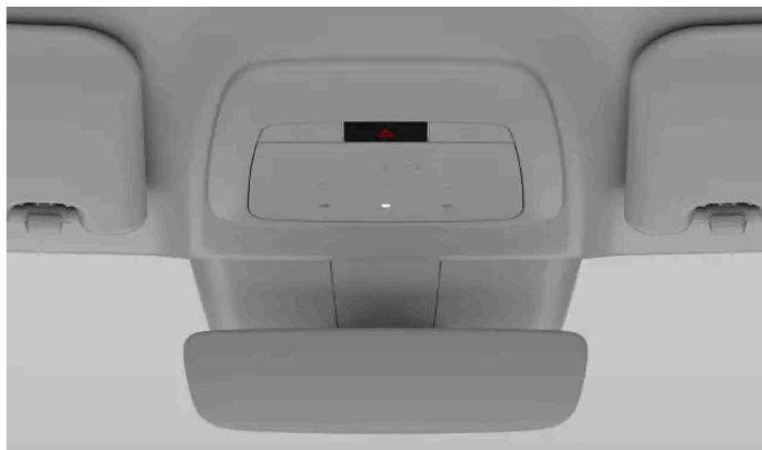
Umístění tlačítka výstražných světel na stropním panelu
