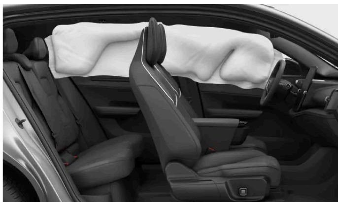
Nafouknutý hlavový airbag na jedné straně vozidla.
