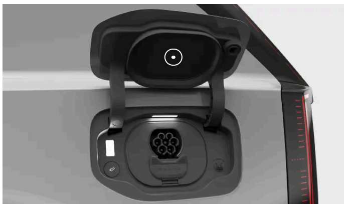
Identifikační štítek je na vnitřní straně víka nabíjecího portu.
