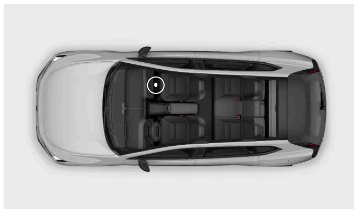
Umístění kódu VIN na nosníku pod sedadlem spolujezdce
