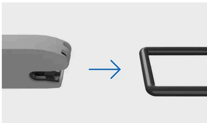
Upevnění pomocí kotevního bodu ISOFIX
