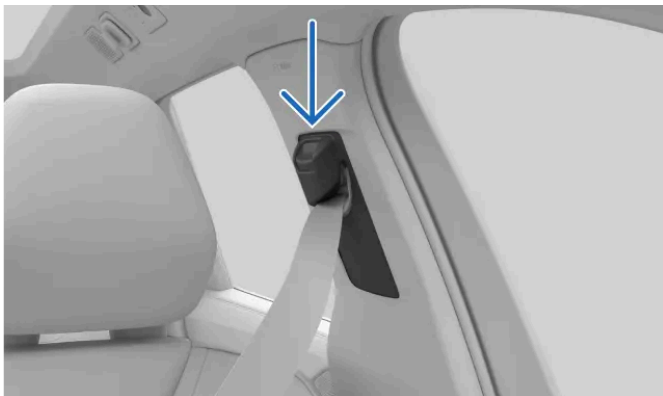
Horní kotevní bod bezpečnostního pásu
