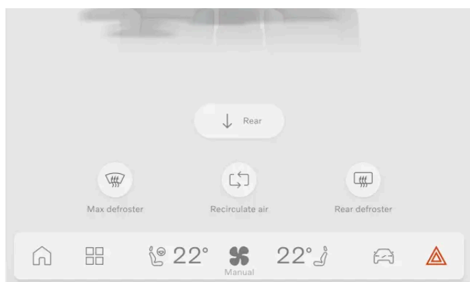
Umístění tlačítka výstražných světel na středovém displeji
