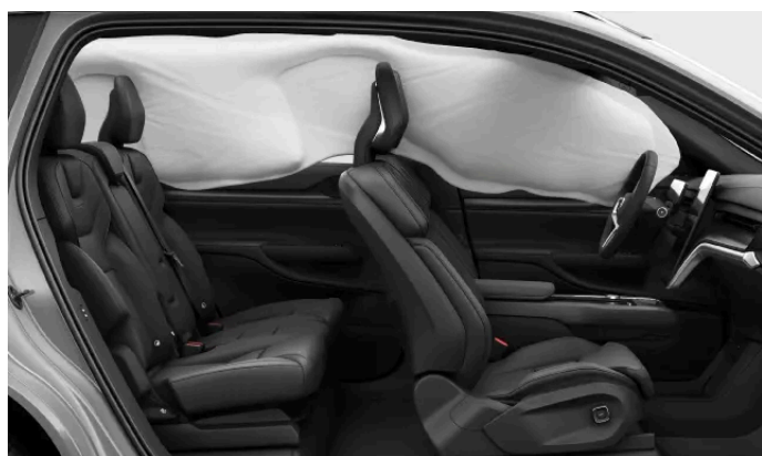
Nafouknutý hlavový airbag na jedné straně vozidla.
