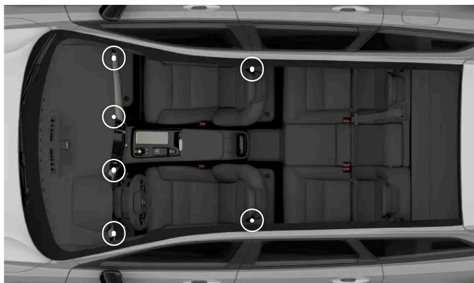
Rozmístění nastavitelných ventilačních otvorů
