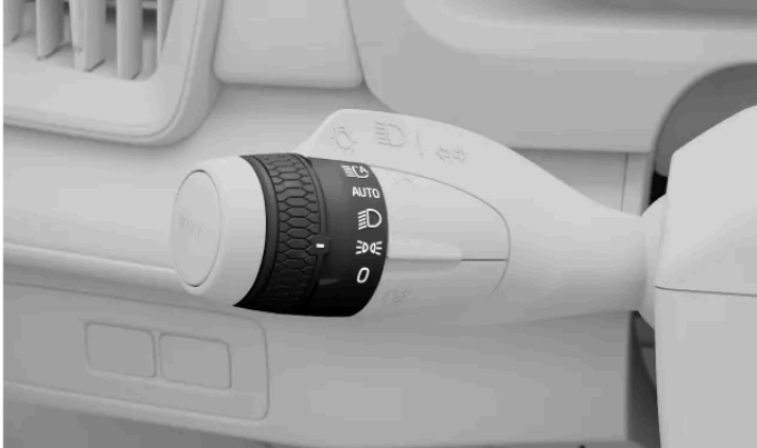
Symbol obrysových světel na otočném ovladači levého páčkového přepínače.
