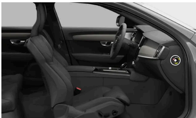
Umístění přepínače airbagu spolujezdce
