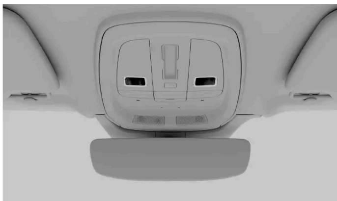
Přední čtecí lampičky na stropním panelu
