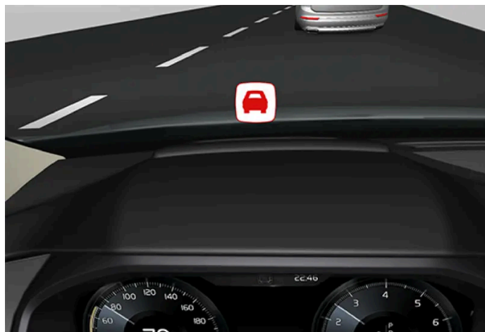
Symbol varování před kolizí na čelním skle
