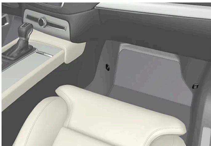
Umístění upevňovacích bodů na předním sedadle.
