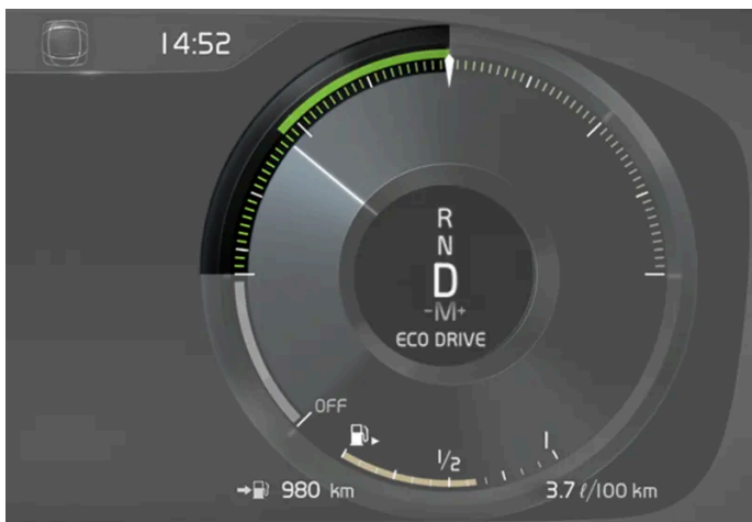
Indikace Eco na 12" displeji řidiče*.
