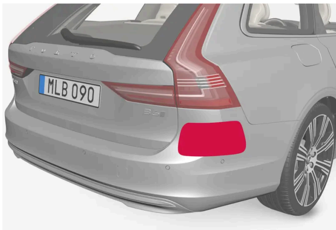
Umístění zadních radarových jednotek
