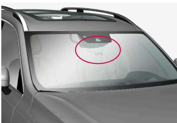
Umístění přední kamery a radarové jednotky
