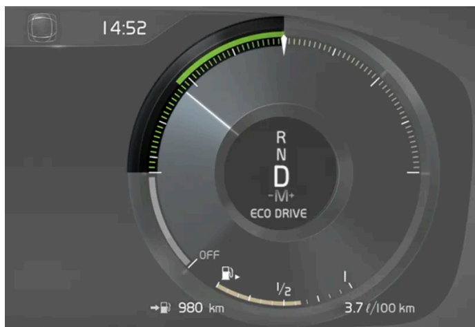
Indikace Eco na 12" displeji řidiče*.
