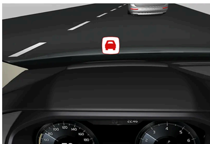
Symbol varování před kolizí na čelním skle
