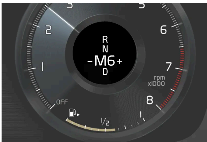
Indikace řazení na 12" displeji řidiče u malé řadicí páky*.
