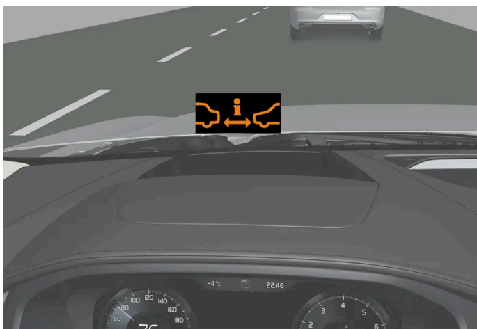
Kontrolka Upozornění na odstup na čelním skle s head-up displejem.
