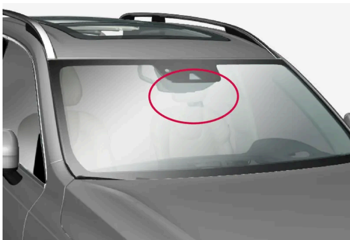
Umístění přední kamery a radarové jednotky
