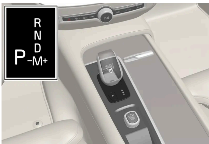
Přehled - řadicí páka a schéma řazení na displeji řidiče.
