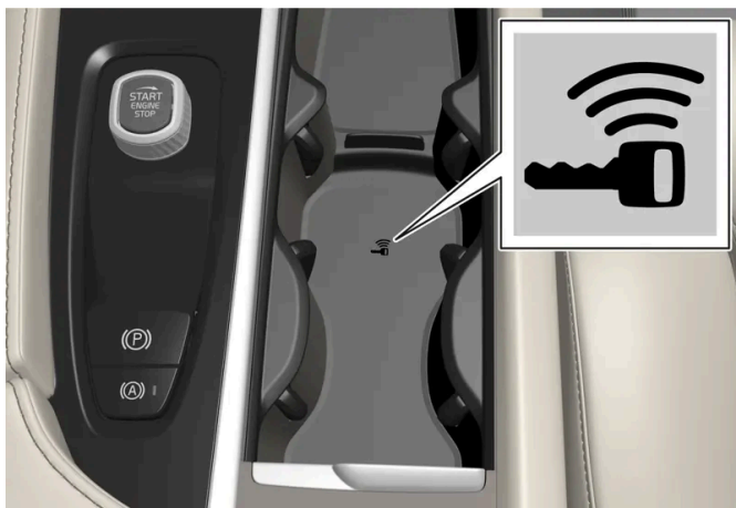
Umístění záložní čtečky v tunelové konzole.
