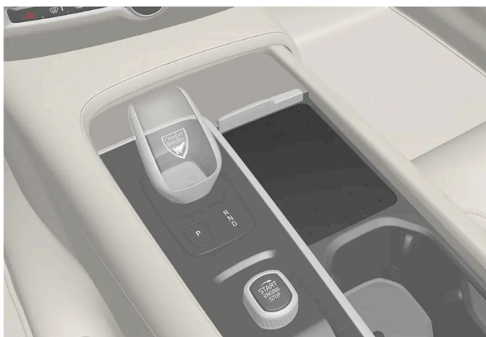
Bezdrátová nabíječka telefonu v tunelové konzole.
