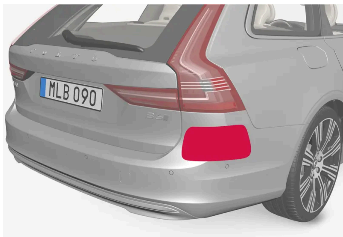
Umístění zadních radarových jednotek
