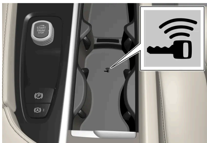
Umístění záložní čtečky v tunelové konzole.
