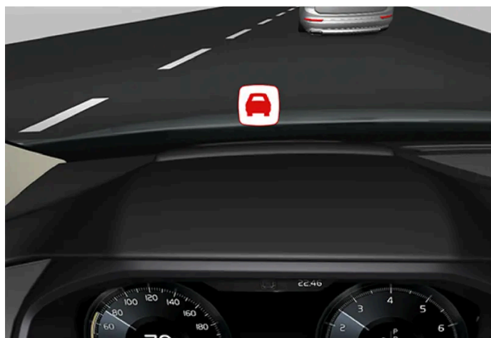
Symbol varování před kolizí na čelním skle
