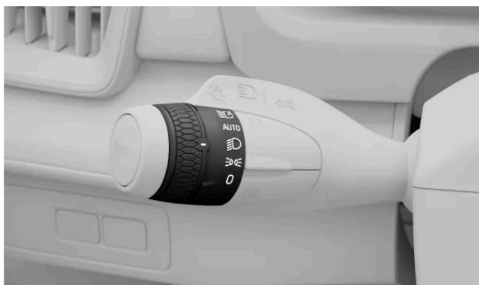
Symbol potkávacích světel na otočném ovladači levého páčkového přepínače.
