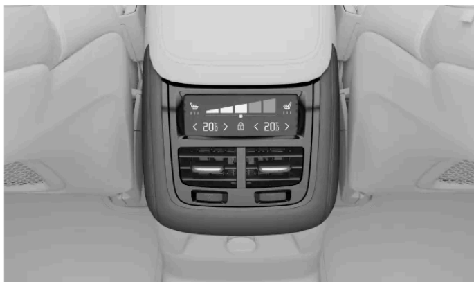
Ovládání klimatizace na tunelové konzole
