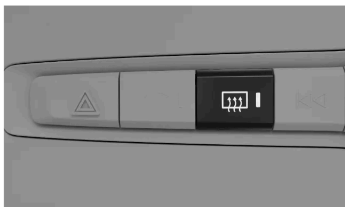
Tlačítko odmrazování zadního skla na tlačítkovém panelu pod středovým displejem
