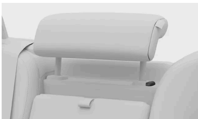
Blokovací tlačítko na hlavové opěře
