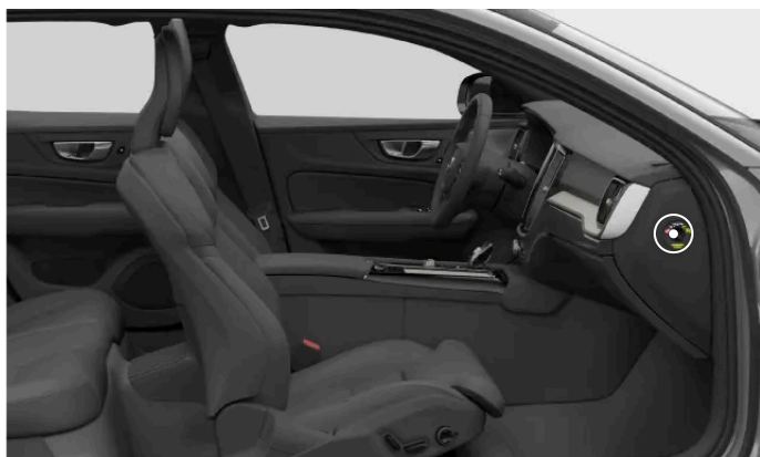
Umístění přepínače airbagu spolujezdce
