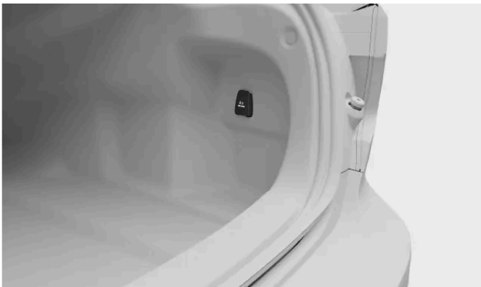
12V elektrickou zásuvku najdete po pravé straně kufru.
