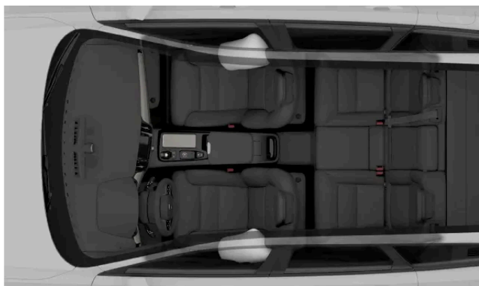
Airbasy na ochranu předních pasažérů při nárazu do boku vozidla.
