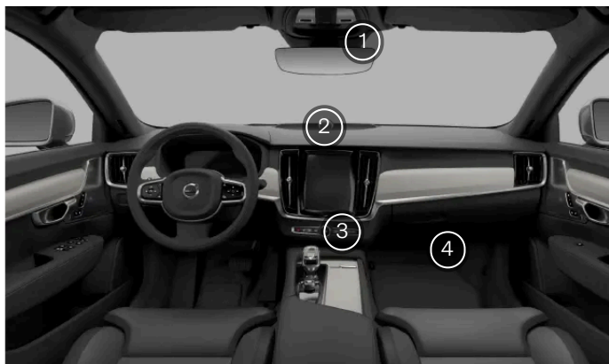
Senzory klimatu v interiéru
