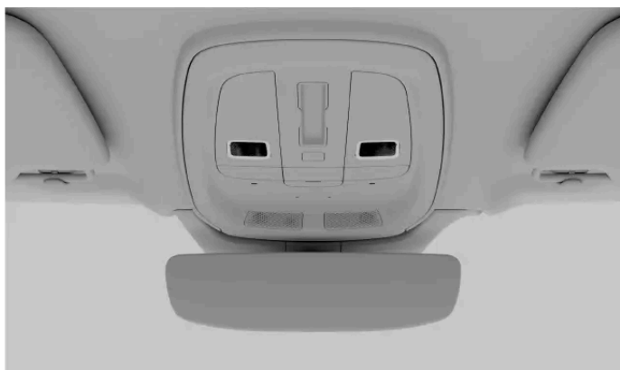
Přední čtecí lampičky na stropním panelu
