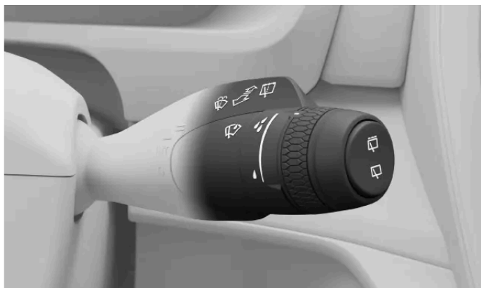
Páčkový přepínač napravo od volantu
