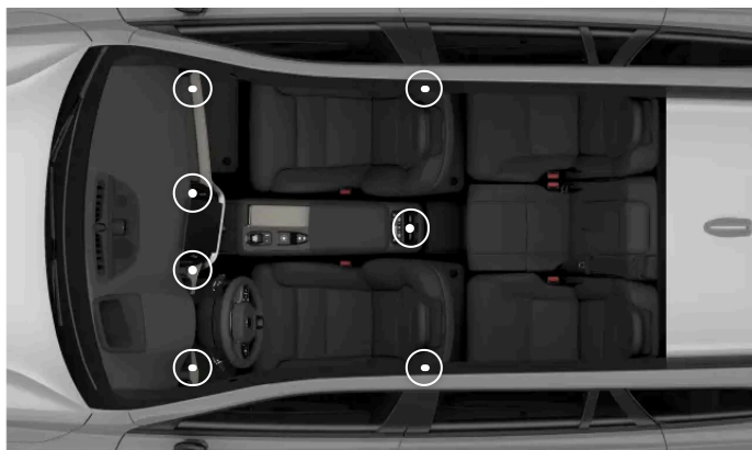
Rozmístění nastavitelných ventilačních otvorů
