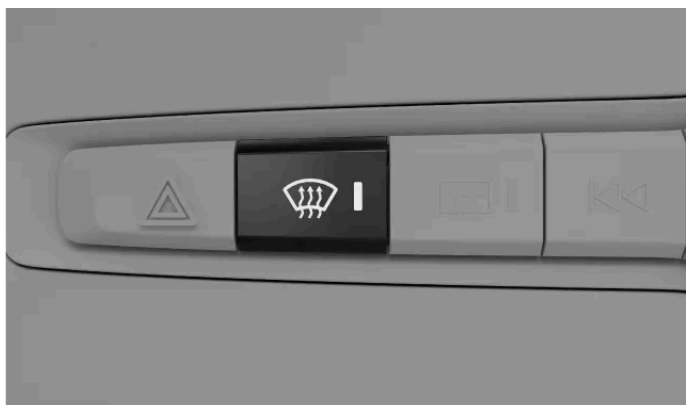
Tlačítko maximálního odmrazování na tlačítkovém panelu pod středovým displejem
