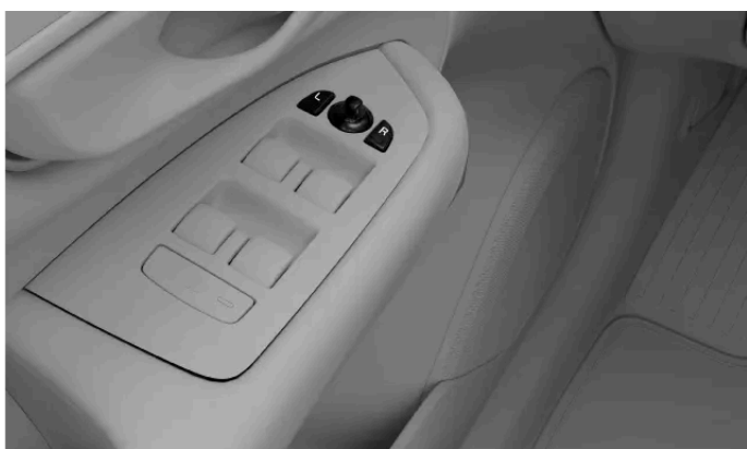
Ovládací prvky pro nastavení vnějších zpětných zrcátek
