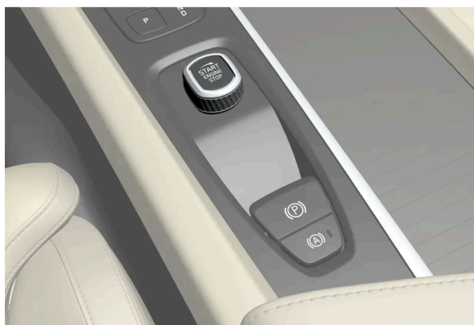
Startovací knoflík na tunelové konzole.
