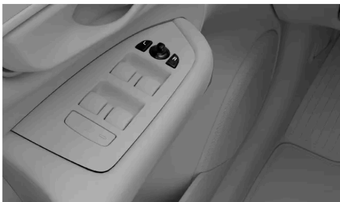
Ovládací prvky pro nastavení vnějších zpětných zrcátek
