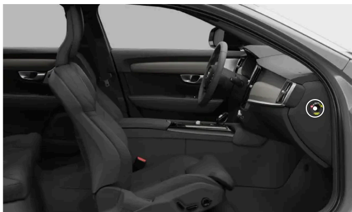
Umístění přepínače airbagu spolujezdce
