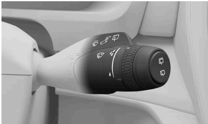
Páčkový přepínač napravo od volantu
