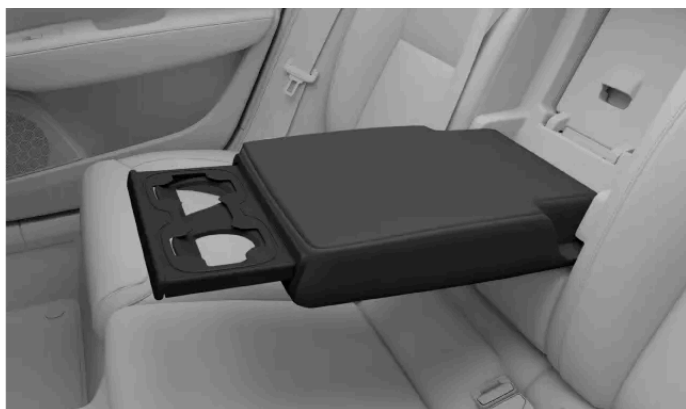
Loketní opěrka uprostřed zadních sedadel s vysunutým držákem nápojů.
