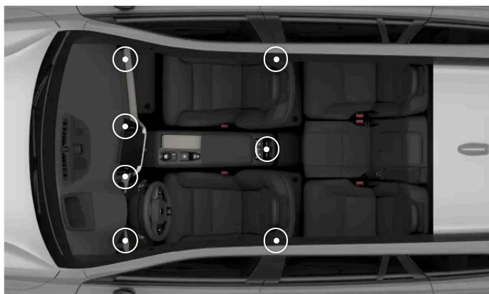
Umístění nastavitelných ventilačních otvorů
