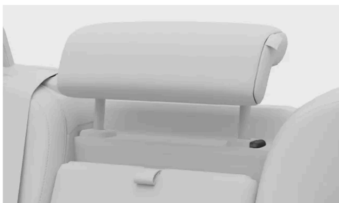
Blokovací tlačítko na hlavové opěrce
