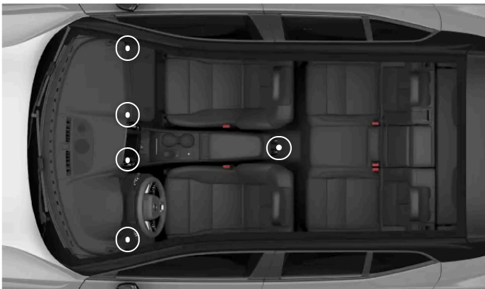
Umístění nastavitelných ventilačních otvorů
