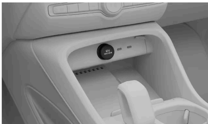
12V elektrická zásuvka v tunelové konzole
