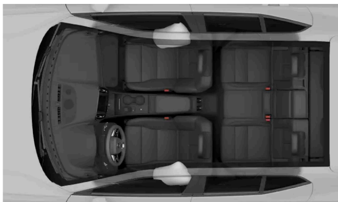
Airbagy na ochranu předních pasažérů při nárazu do boku vozidla.
