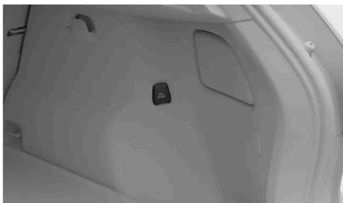
12V elektrickou zásuvku najdete po pravé straně kufříku.
