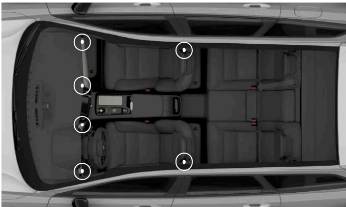
Umístění nastavitelných ventilačních otvorů
