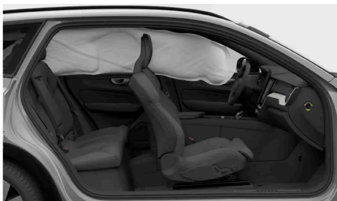
Nafouknutý hlavový airbag na jedné straně vozidla.
