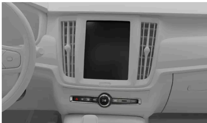
Středový displej a tlačítka odmrazování na tlačítkovém panelu pod středovým displejem
