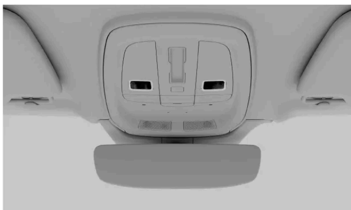
Přední čtecí lampičky na stropním panelu
