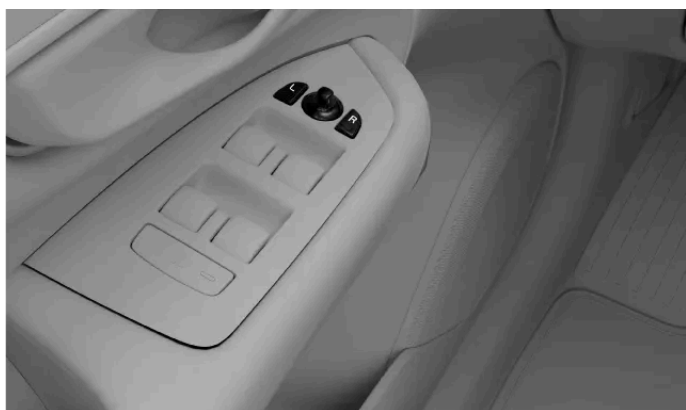
Ovládací prvky pro nastavení vnějších zpětných zrcátek
