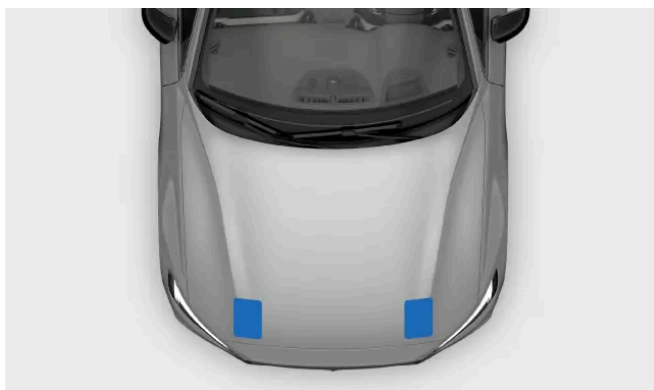
Místo k zatlačení na kapotu při jejím zavírání
