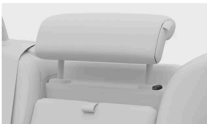
Blokovací tlačítko na hlavové opěrci
