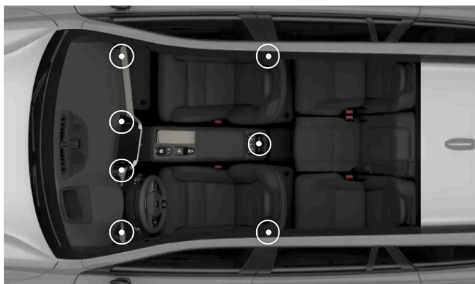
Rozmístění nastavitelných ventilačních otvorů
