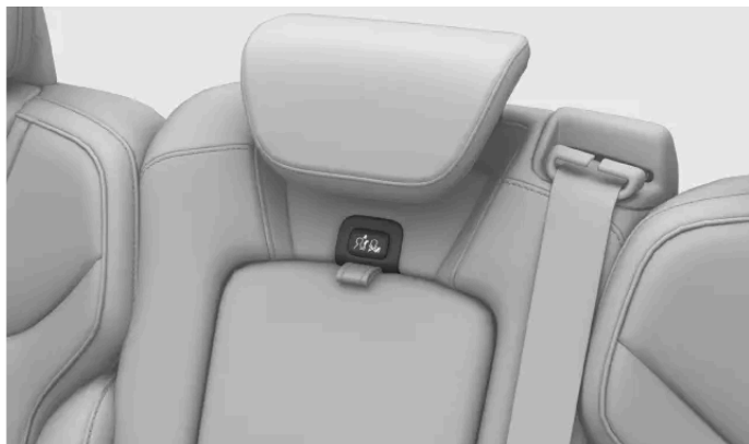
Blokovací tlačítko na prostřední hlavové opěrce
