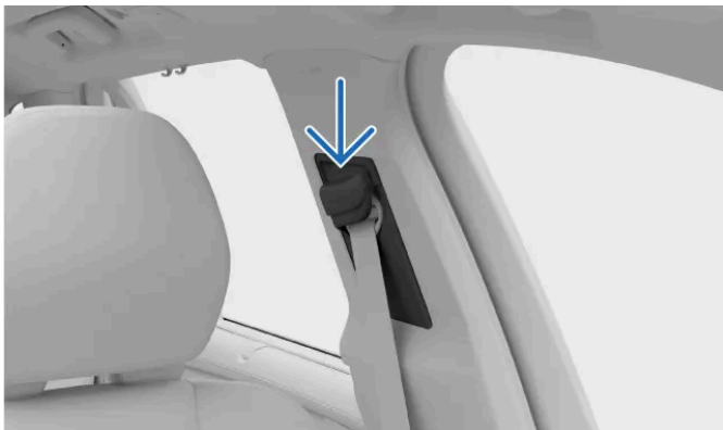
Horní kotevní bod bezpečnostního pásu
