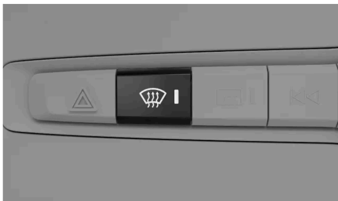
Tlačítko maximálního odmrazování na tlačítkovém panelu pod středovým displejem
