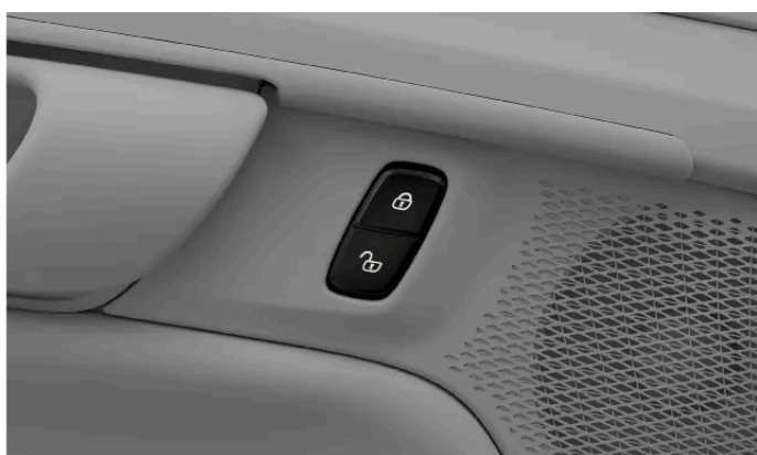
Tlačítko centrálního zamykání na předních dveřích
