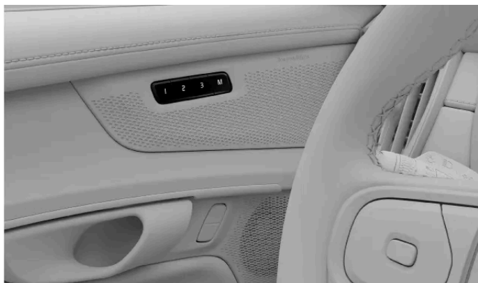
Umístění tlačítek předvolených nastavení sedadel
