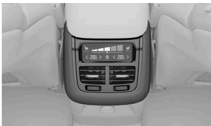
Ovládání klimatizace na tunelové konzole
