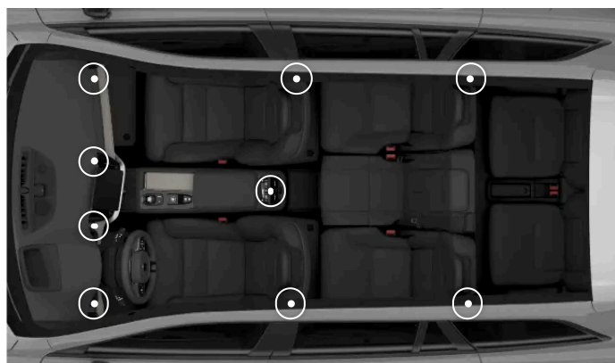
Umístění nastavitelných ventilačních otvorů
