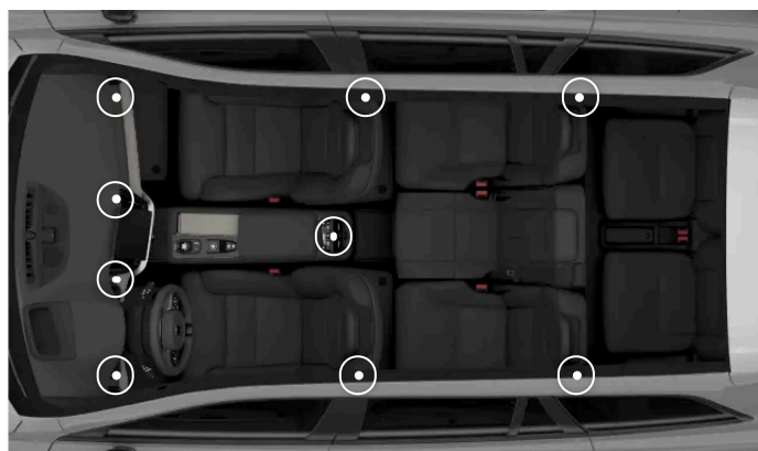
Umístění nastavitelných ventilačních otvorů
